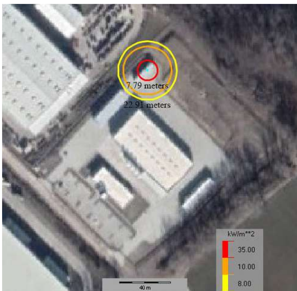
A 2.3.GTH szcenárió azonnali gyulladás esetén megvalósuló következménye
